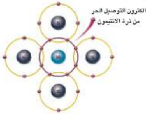
شكل (13) بلورة شبه موصل نوع (N)
