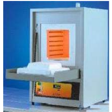
فرن الحرق يستعمل لحرق الراسب عند درجات حرارية عالية قد تتجاوز 1000^\circ\text{C}
