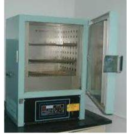
فرن التجفيف يستعمل لتجفيف الراسب عند درجات حرارية عالية قد تصل 100^\circ\text{C}
