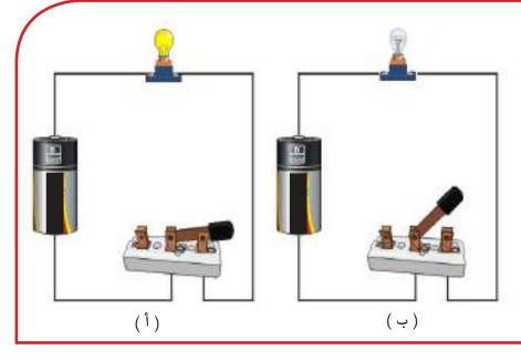
أصف عمل المفتاح الكهربائي في الدارتين الكهربائيتين.
