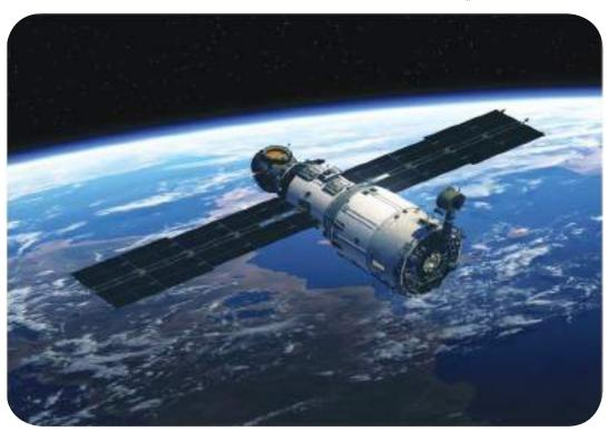
تزُود الاقمار الصناعية بالواح الخلايا الشمسية لمدها بالطاقة الكهربائية
