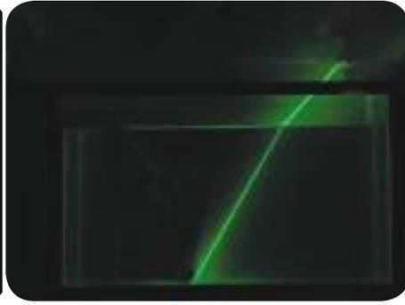
ينكسر الضوء عند انتقاله من الهواء إلى الماء بشكل مائل.
