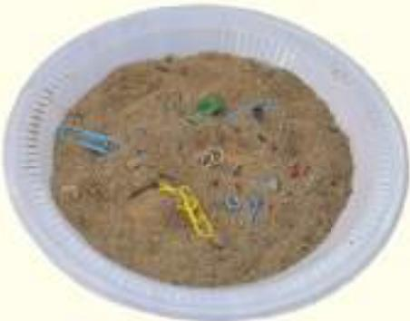
**المغناطيس:** يُمكن فصل مكونات المخلوط إذا كانت تحتوي على مواد حديدية كالمشابك الحديدية وأخرى غير حديدية كالازرار البلاستيكية باستعمال المغناطيس.
